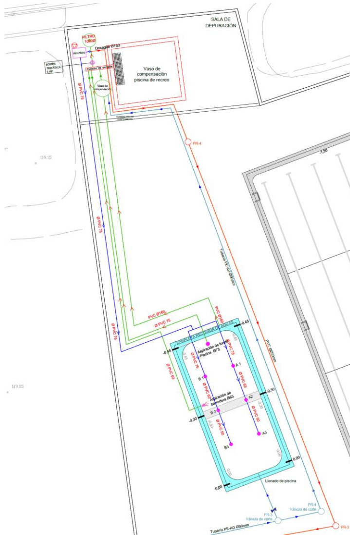
Detalle. Sistema de aspiración y llenado piscina de chapoteo.
