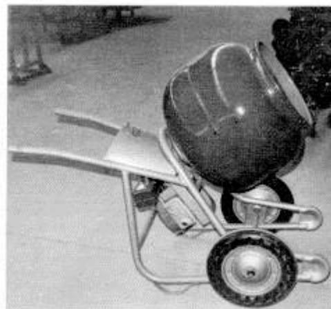
**Fig. 7: Hormigonera de gasolina**
