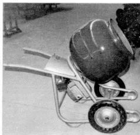
Fig. 8: Hormigonera de gasolina con motor protegido de las caídas de diversos
